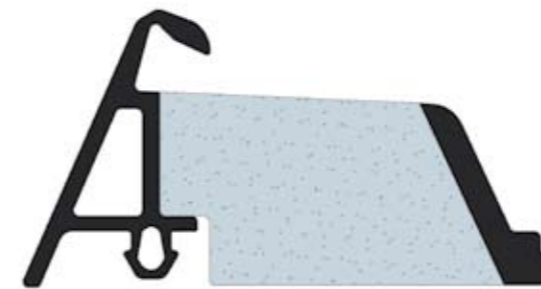
Mitteldichtung für Fenster und Fassadensysteme in EPDM / Moosgummikombination für eine optimierte Wärmedämmung.
