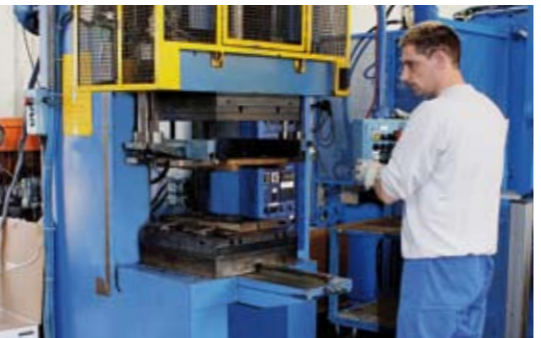
Auf den Vulkanisationspressen von Dätwyler Rubber Deutschland können Formen mit einer maximalen Grösse von 50 x 60 cm eingesetzt werden.
