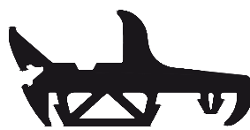
Einsatz im Waggonbau Profil für Waggonverglasungen
