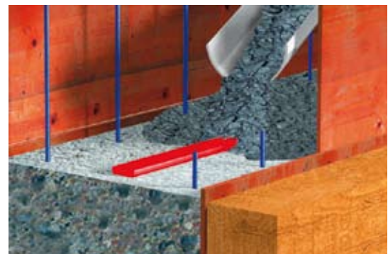
In Arbeitsfuge verlegtes Profil während des Betonierens der nächsten Etappe.
